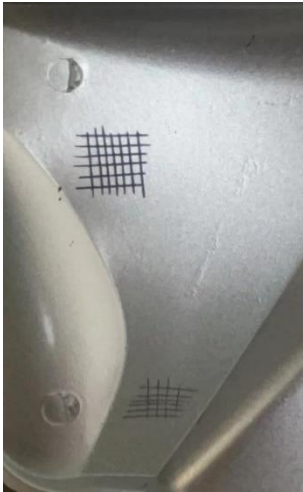
优异的附着力和面漆配套性 涂层体系：灰色底漆+银粉面漆
